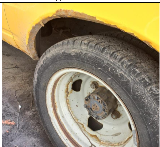
ГАЗ-322121, состояние колёс, коррозия крыльев
