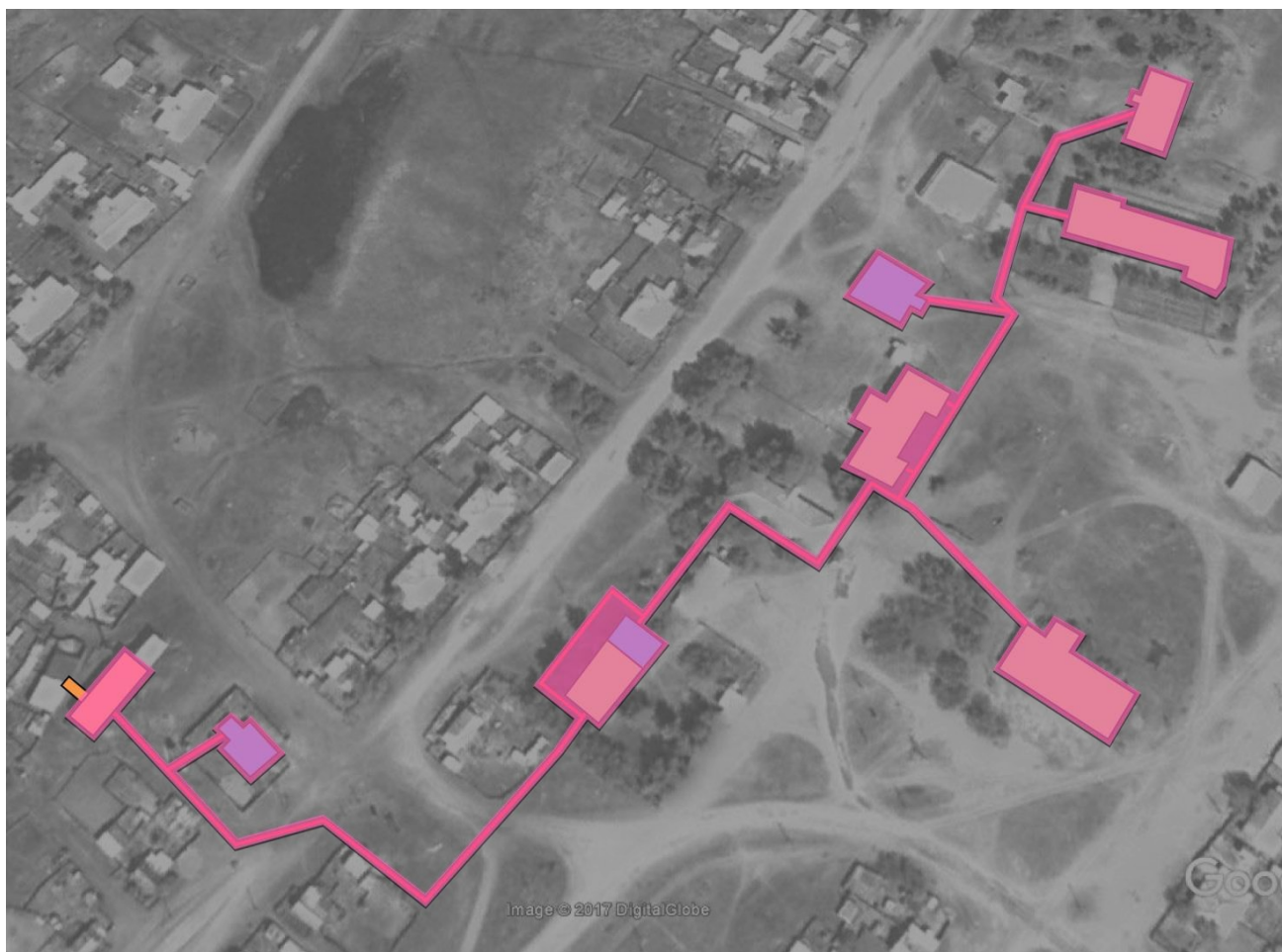
Рисунок А – Зона действия котельной, с. Большая Шелковка ООО «Компания теплоснабжения» на территории с. Большая Шелковка Большешелковниковского сельсовета Рубцовского района Алтайского края
